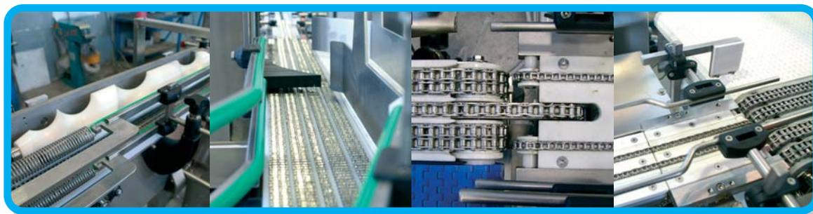
**CARATTERISTICHE DI BASE:** struttura robusta ed ergonomica; realizzazione in acciaio verniciato o completamente in acciaio inox; altezza di lavoro, senso di marcia e configurazione su misura del cliente; motorizzazione asincrona, protetta da lavaggi e contaminazioni, controllata da inverter tramite tastiera e salvata tra i parametri prodotto per un rapidi cambio formato; quadro elettrico inserito nella struttura o remoto.
