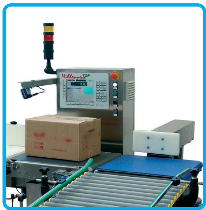
**CARATTERISTICHE DI BASE:** struttura robusta ed ergonomica in acciaio verniciato o completamente inox; altezza di lavoro, senso di marcia e configurazione su misura del cliente; nastro multitela idoneo al prodotto trattato; motorizzazione asincrona; quadro elettrico inserito nella struttura o remoto.
