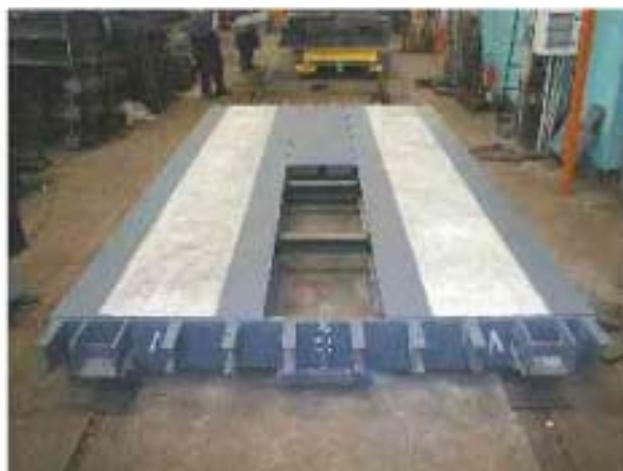
L'innovativo sistema costruttivo consente di ottenere una stadera a ponte modulare per uso stradale in **ferro-cemento**. È costruita in versione compatta, in modo che l'altezza dell'impianto sia contenuta in circa cm 40. L'impianto può quindi essere installato in una buca di circa 50 cm, o fuori terra. In tal caso al piano di carico si accedeva a mezzo rampe di modesta pendenza.
